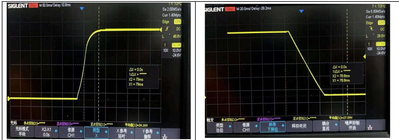
图(5) 25%~50%负载动态波形
